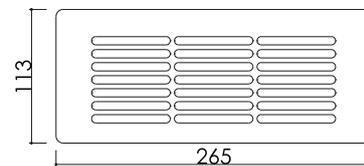
**Blende QUADRO (Lüftungsgitter 100 mm)**
