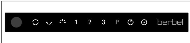
Die Position des Bedienfelds ist an der Mulde der EIN/AUS-Taste jederzeit zu erkennen. Die übrigen Tasten leuchten, wenn das Gerät eingeschaltet ist.
