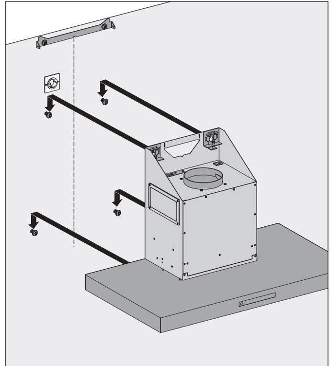
☞ Hängen Sie das Gerät an den Befestigungspunkten auf.
