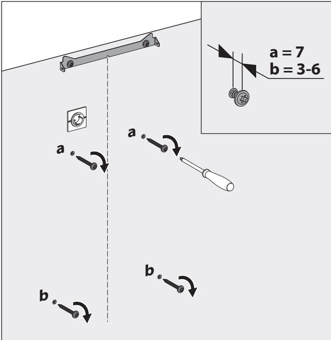
Die oberen Befestigungsschrauben werden erst nach Ausrichtung des Geräts festgezogen.
