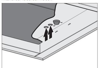
□ Drücken Sie am Gerät gleichzeitig die beiden Zusatzknöpfe (> 3 Sek.). Der Verbindungsprozess kann bis zu 2 Minuten dauern.
