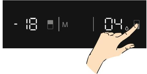
Die Temperatur im **Gefrierteil (B)** und des Modus "Super-Gefrieren" kann weiterhin manuell eingestellt werden. Auch nach einer Änderung der Temperatur des **Gefrierteils (B)** wird der Modus "Super-Kühlen" fortgesetzt.
