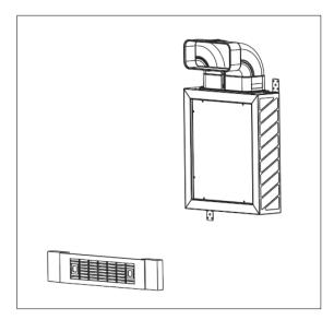
Desweiteren muss eine Luftaustrittsöffnung am Sockel eingerichtet werden (z.B. durch die Platzierung eines Luftgitters in die Sockelwand), damit die am Gerät ausströmende Luft im Sockel keinen Staudruck verursacht, sondern wieder in die Küche strömen kann.
