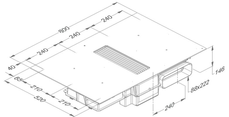
\*Bei Montage direkt an einer ungedämmten Außenwand empfehlen wir die Verwendung eines Einbausatzes mit Luftauslass im Sockel.
